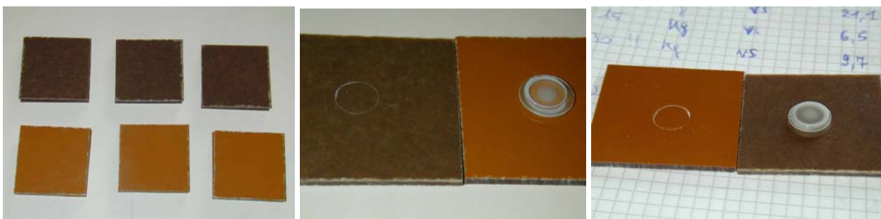
Fig. 8 Primi test di scollatura con bachelite CMS vecchio e nuovo tipo.
